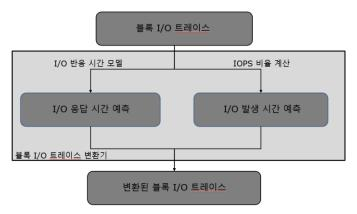
그림 1 블록 I/O 트레이스 변환기의 변환 과정
