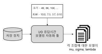
그림 2 I/O 반응 시간 모델링 자동화 툴의 동작 방식
